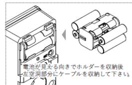
電池が見える向きでホルダーを収納後、左空洞部分にケーブルを収納して下さい。
